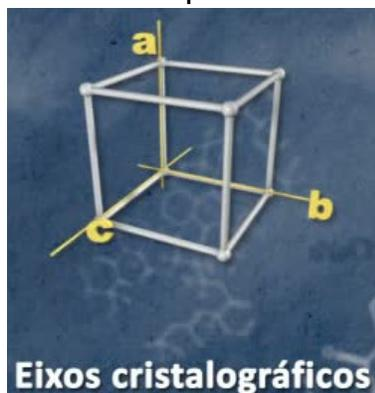
A célula unitária se repete na direção dos eixos cristalográficos formando um reticulado.
