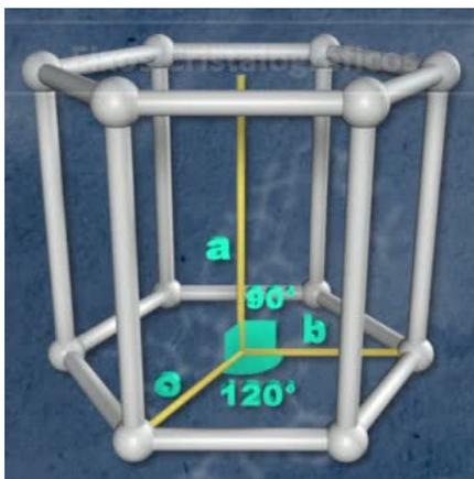
A esmeralda é um cristal classificado neste sistema. Nos cristais do sistema hexagonal ocorrem simetrias entre as do prisma hexagonal.
