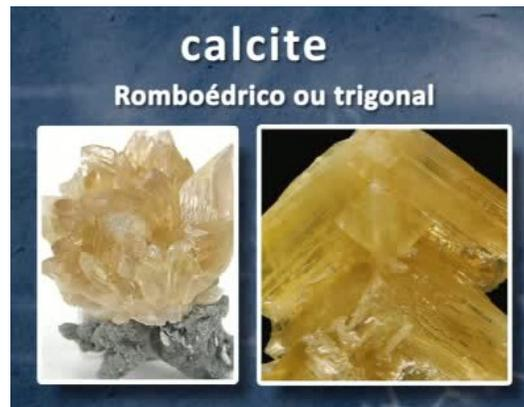
As faces das formas poliédricas dos cristais deste sistema são losangos e os 3 eixos cristalográficos são iguais formando, dois a dois, ângulos diferentes de 90 graus.
